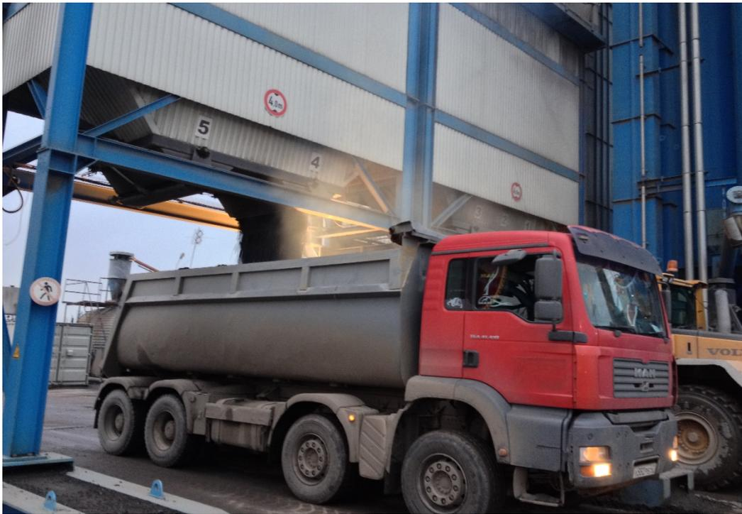
Рис.6 Загрузка самосвала асфальтобетонной смесью с модификатором «Dorflex BA».
