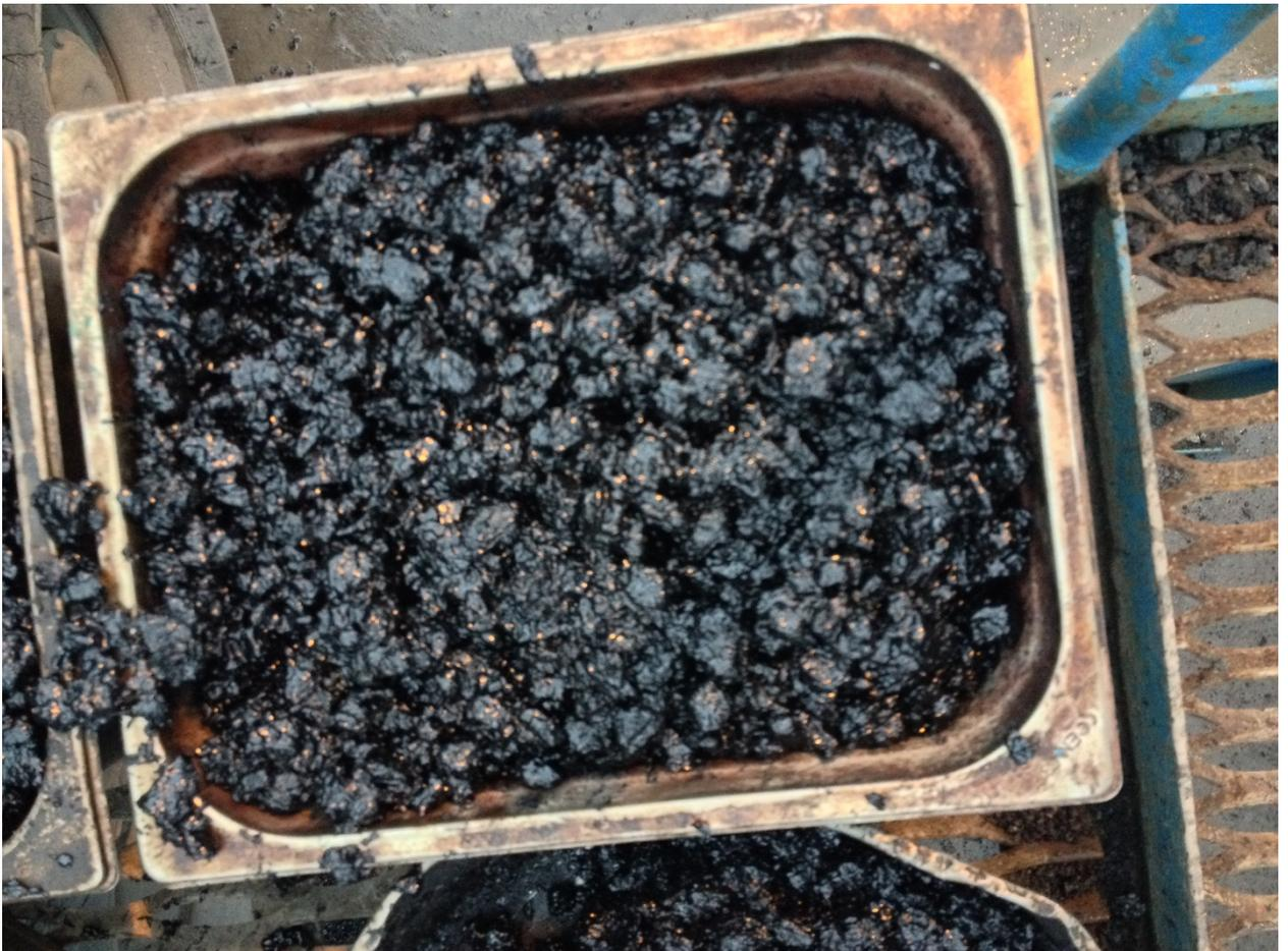
Рис.7 асфальтобетонная смесь для отбора контрольных образцов.
