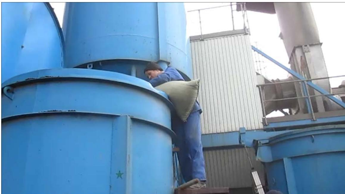
Рис.5 засыпка гранул «DorFlex ВА» в смеситель АБЗ
